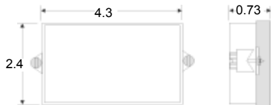
AA923 GM NEMA-4 Splashguard for all DIN
